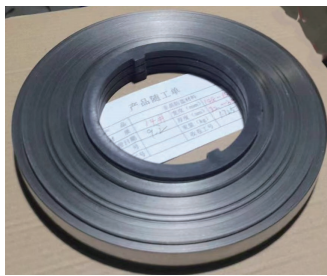
图 2 KNiCr-5 非晶态镍基中间层 Fig.2 KNiCr-5 nickel base interlayer amorphous foil
